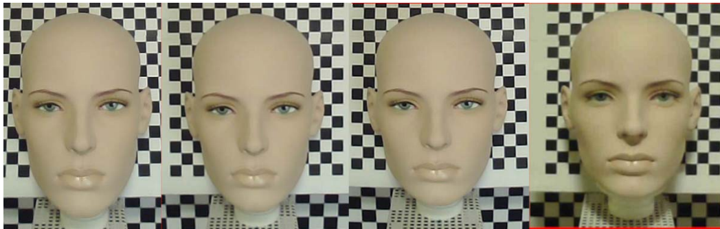
11. A 4 arckép egymás mellé helyezve azonos szemtávolsággal, egyértelműen látható a korrekció pozitív hatása (bal szélén a korrekció nélküli kép, jobb szélén az optimális fizikai elrendezésű).
